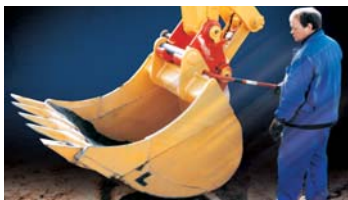
Schlüssel einstecken, um ca. 110° drehen: sicher verriegelt!
