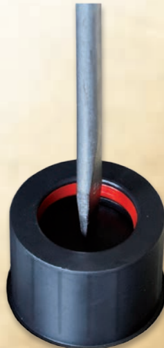
Den Dichtring in die Nut springen lassen.
