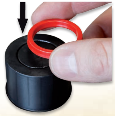
Neuen Dichtring zusammendrücken und mit der offenen Seite nach unten auf die Dichtscheibe auflegen.
