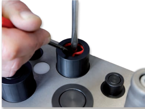
Dichtscheibe des Kupplungssteckers mit einem Schraubendreher niederdrücken und oberen Dichtring (rot) mit einem spitzen Werkzeug entfernen.
